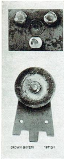
Abb. 37. Kontaktbolzen und Teller eines Motors mit Zentrifugalanlasser für Zentrifugenantriebe nach etwa 100 000 Schaltungen.
